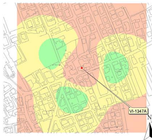
Livelli di Campo Elettrico prodotto dalle Stazioni Radio Base a 5 m sul livello del suolo
