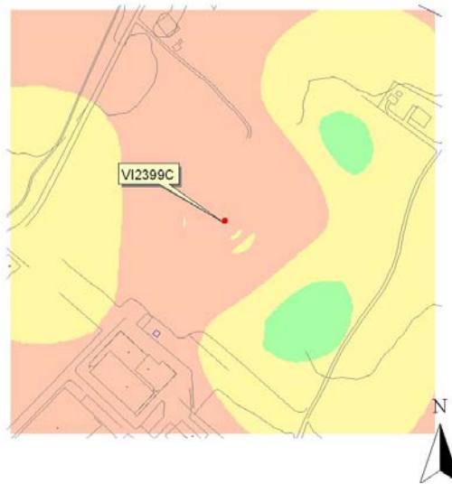
Livelli di Campo Elettrico prodotto dalle Stazioni Radio Base a 5 m sul livello del suolo
